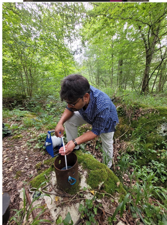
FIGURE 2.5 – Piézométrie. À gauche et de haut en bas : schéma d'un piézomètre, courbe piézométrique du puits de village de Villiers en Bière (77). À droite et de haut en bas : Sonde piézométrique manuel, relevé dans un piézomètre en forêt de Fontainebleau (Sources externes : wikimédia pour la schéma d'un piézomètre).
