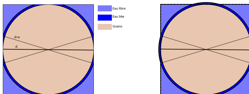
FIGURE 1.4 – Vue en plan d'un cube contenant une sphère. À gauche, le cube et les deux volumes d'eau (libre = porosité efficace, liée = capacité de rétention). À droite schéma montrant les calottes qui dépassent du cube
