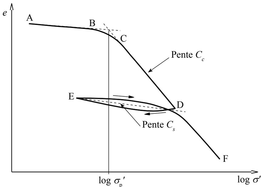
Figure 6: exploitation de la courbe de compressibilité.
