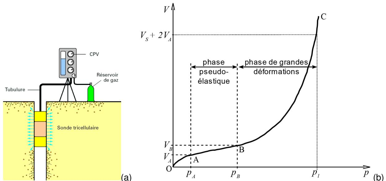
FIGURE 2.10 – (a) pressiomètre en place ; (b) courbe pressiométrique.
