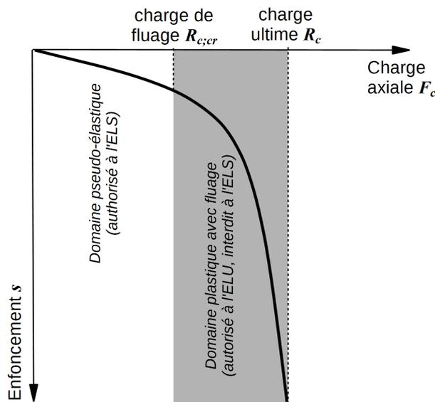
FIGURE 3.9 – Comportement d'un pieu sous l'action d'une charge croissante de compression axiale.
