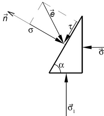
**FIGURE 1.7** – Contraintes s'appliquant sur une facette d'orientation  $\alpha$ .
