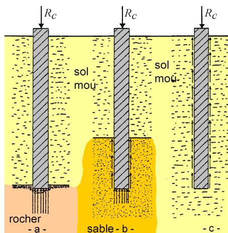
FIGURE 3.3 – Différents modes de fonctionnement d'un pieu pour différents types d'ancrage.
