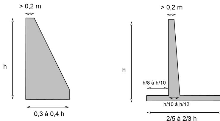
FIGURE 4.24 – Mur trapézoïdal
