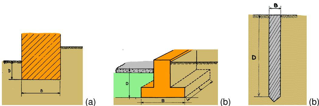
FIGURE 2.1 – (a) et (b) fondations superficielles, (c) pieu.
