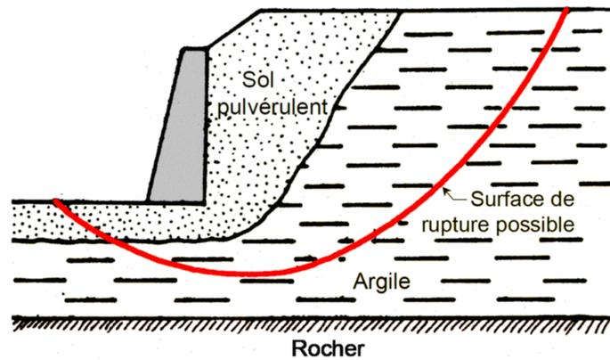
FIGURE 4.8 – Surface de rupture circulaire dans un massif de sol intégrant un mur de soutènement.
