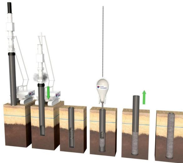
**FIGURE 3.4** – Pieu battu moulé sur place : 1. mise en place du tube de battage avec plaque métallique perdue, 2. enfoncement du tube par battage, 3. mise en place de l'armature, 4. bétonnage du fût du pieu, 5. extraction du tube de battage, 6. pieu battu moulé achevé (d'après atlas-fondations.fr).
