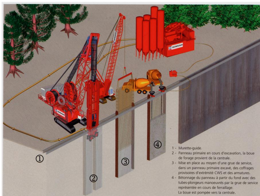
FIGURE 4.5 – Principe de réalisation d'une paroi moulée.
