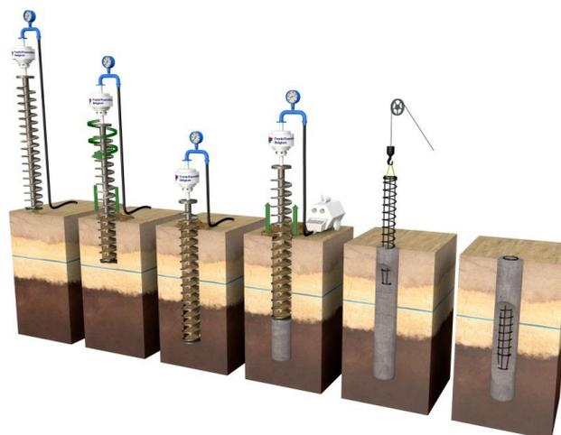
**FIGURE 3.5** – Pieu foré avec une tarière creuse : 1. positionnement de la tête de forage, 2. & 3. vissage de la tarière, 4. injection sous pression de béton dans l'axe creux de la tarière au fur et à mesure du retrait de la tarière (sans rotation), 5. mise en place de l'armature, 6. pieu foré achevé (d'après atlas-fondations.fr).
