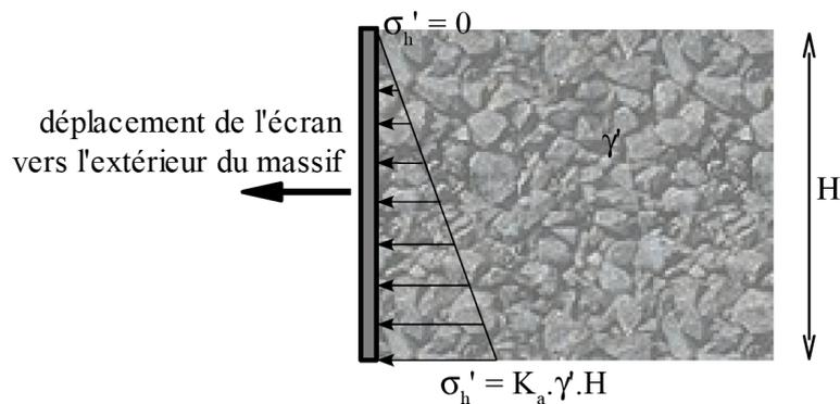
FIGURE 4.12 – Contraintes horizontales s'exerçant dans le cas de la poussée.
