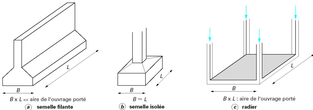
FIGURE 2.2 – Différents types de fondations superficielles.
