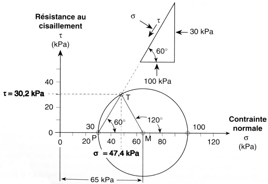
FIGURE 1.9 – Exemple de calcul des contraintes à l'aide du cercle de Mohr pour  $\sigma_1 = 100$  kPa,  $\sigma_3 = 30$  kPa et  $\alpha = 30^\circ$ .
