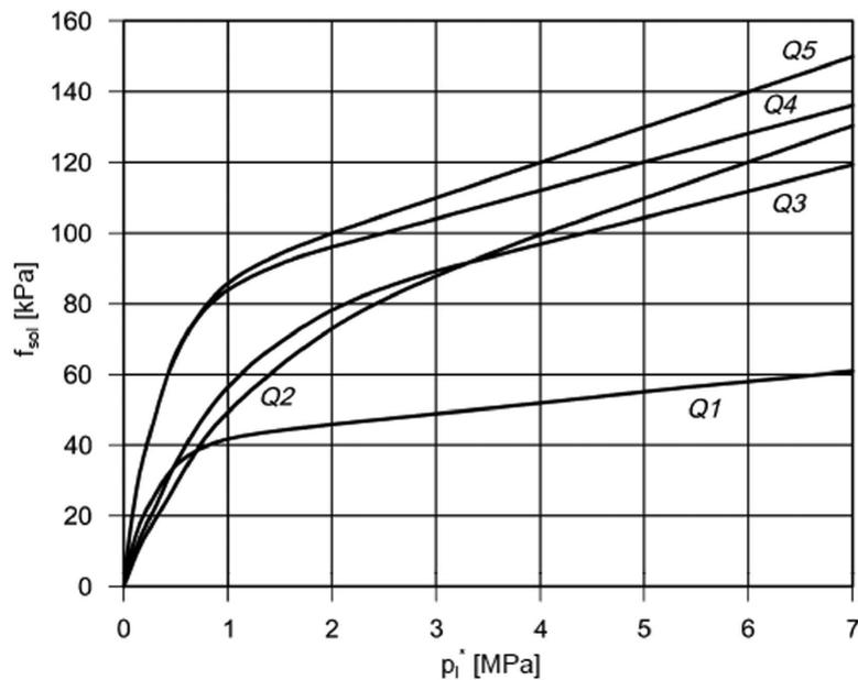
**FIGURE 3.8 – Abaque donnant la valeur de  $f_{\text{sol}}$  en fonction de la pression limite et de la nature de la couche de sol.**
