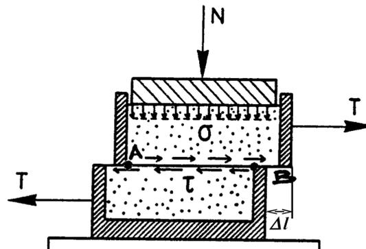
FIGURE 1.3 – Appareil de cisaillement direct.
