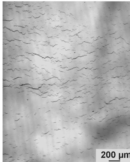
Figure 71 : Réseau de micro-fissures de fatigue à la surface d'une éprouvette lisse de TA6V (800 MPa,  $R=-1$ ) [Le Biavant, 2000].
