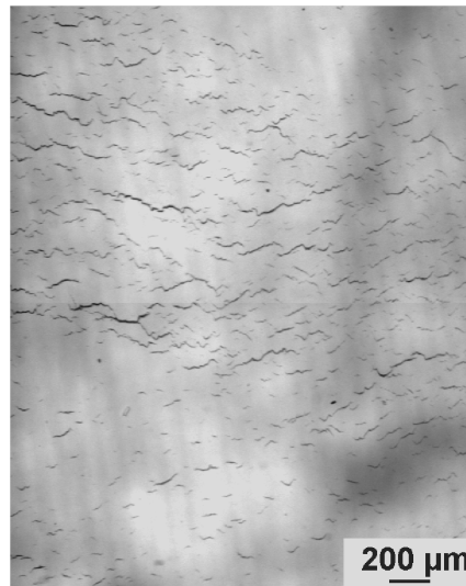
Figure 71 : Réseau de micro-fissures de fatigue à la surface d'une éprouvette lisse de TA6V (800 MPa, R=-1 ) [Le Biavant, 2000].
