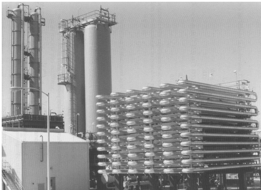
Ensemble réactionnel d'un procédé de dimérisation d'oléfines (Dimersol) mettant en œuvre 2 étages de réacteurs agités (ballons verticaux avec recirculation et un réacteur tubulaire (au premier plan à droite).
