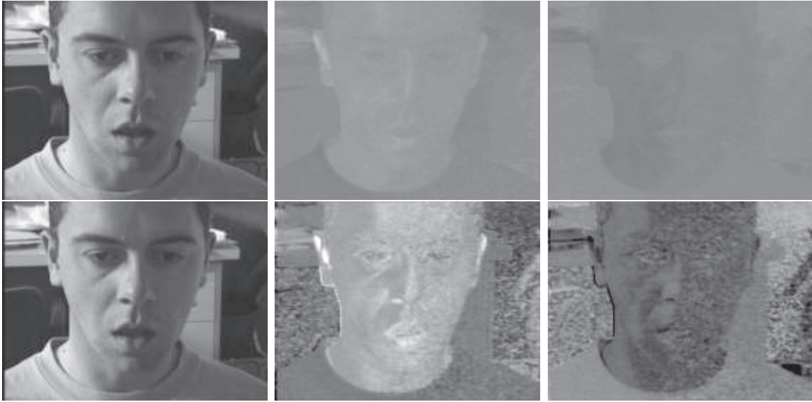
FIGURE 1.18 – Transformées chromatiques sur une image de visage. En haut : Les composantes Y , C_r et C_b ; En bas : Les composantes L , U et X .
