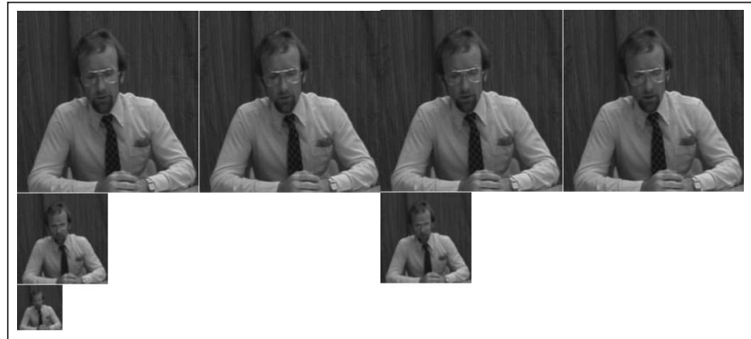
FIGURE 2.7 – Pyramide spatio-temporelle à trois niveaux sur la séquence Trevor (de haut en bas, k = 0, 1, 2 ).
