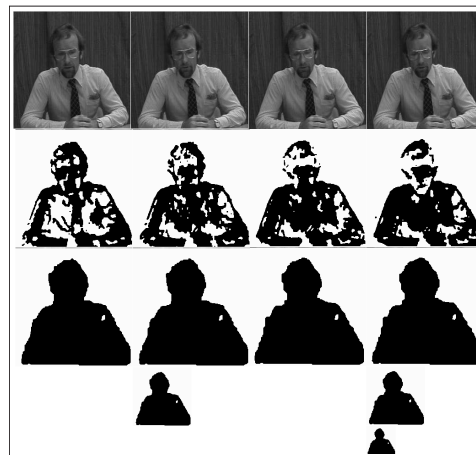
FIGURE 2.8 – Détection de mouvement multirésolution : de haut en bas : 1) séquence Trevor ; 2) masques monorésolution ; 3) masques multirésolution (3 niveaux d'analyse k = 0, 1, 2 ).
