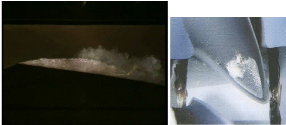
FIGURE I.3 – Cavitation par poches en Venturi (gauche) et sur hélice (droite)
