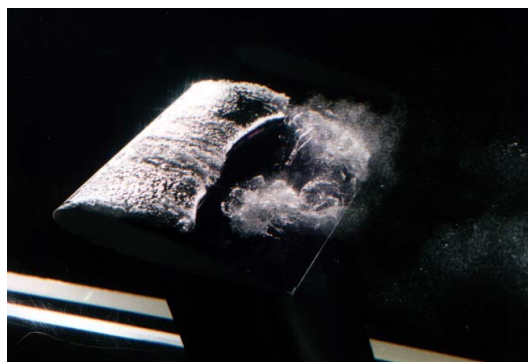
FIGURE I.10 – Poche tridimensionnelle sur hydrofoil
