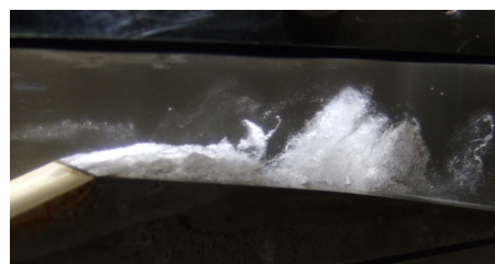
FIGURE V.7 – Schéma du Venturi 8° et visualisation de la poche.
