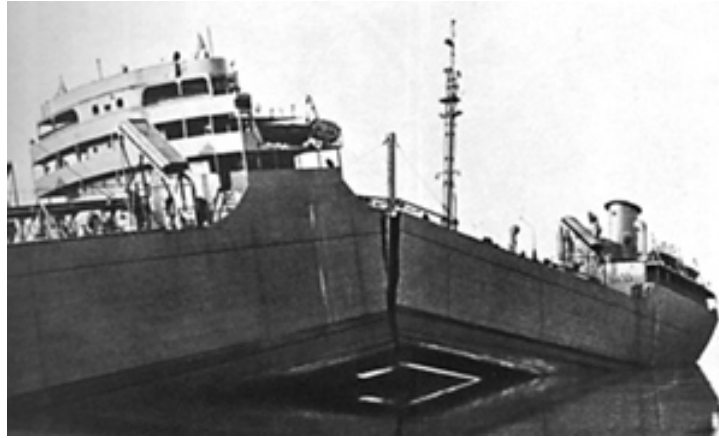
FIGURE 4.9 – Le Schenectady, un des liberty ships entièrement rompus
