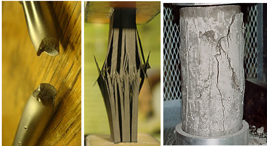
FIGURE 4.6 – Etat final de différentes éprouvettes après un essai uniaxial : à gauche, rupture par striction d’une éprouvette métallique ; au centre, rupture par décohésion des fibres d’un composite à fibres de carbone ; à droite, rupture par fissuration longitudinale d’une éprouvette de béton comprimée.
