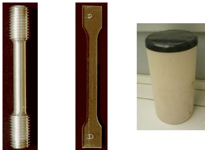
FIGURE 4.1 – Eprouvettes utilisées dans des essais uni-axiaux : à gauche et au milieu, éprouvette cylindrique et éprouvette plate pour un essai de traction ; à droite, éprouvette cylindrique pour un essai de compression.
