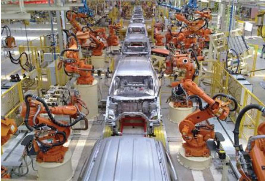
Sur la figure ci-dessus se trouve une image d'une chaîne d'assemblage dans le secteur de l'automobile chinois (le nom du fabricant n'étant pas connu). On remarque clairement que les robots effectuent leurs tâches de manière indépendante de toute intervention humaine (la zone d'assemblage étant délimitée par une barrière jaune de part et d'autre de la ligne d'assemblage). L'entreprise automobile attend de ces robots un taux de production (ou d'assemblage) élevé et de qualité.
