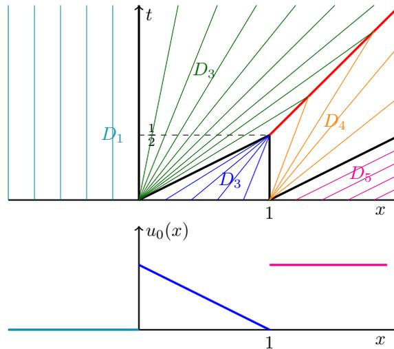
Figure 5.6: 5.6 - En haut : Droites caractéristiques pour l'équation de Burgers avec condition initiale  $u_0$  ; en rouge la ligne de choc, en noir les lignes de discontinuité  $C^1$  – En bas : allure de la condition initiale  $u_0$ .
