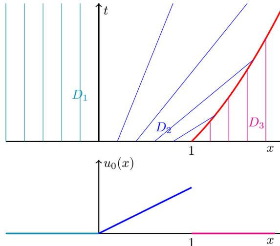
Figure 5.7: En haut : Droites caractéristiques pour l'équation de Burgers avec condition initiale  $u_0$  ; en rouge la ligne de choc, en noir les lignes de discontinuité  $C^1$  – En bas : allure de la condition initiale  $u_0$ .
