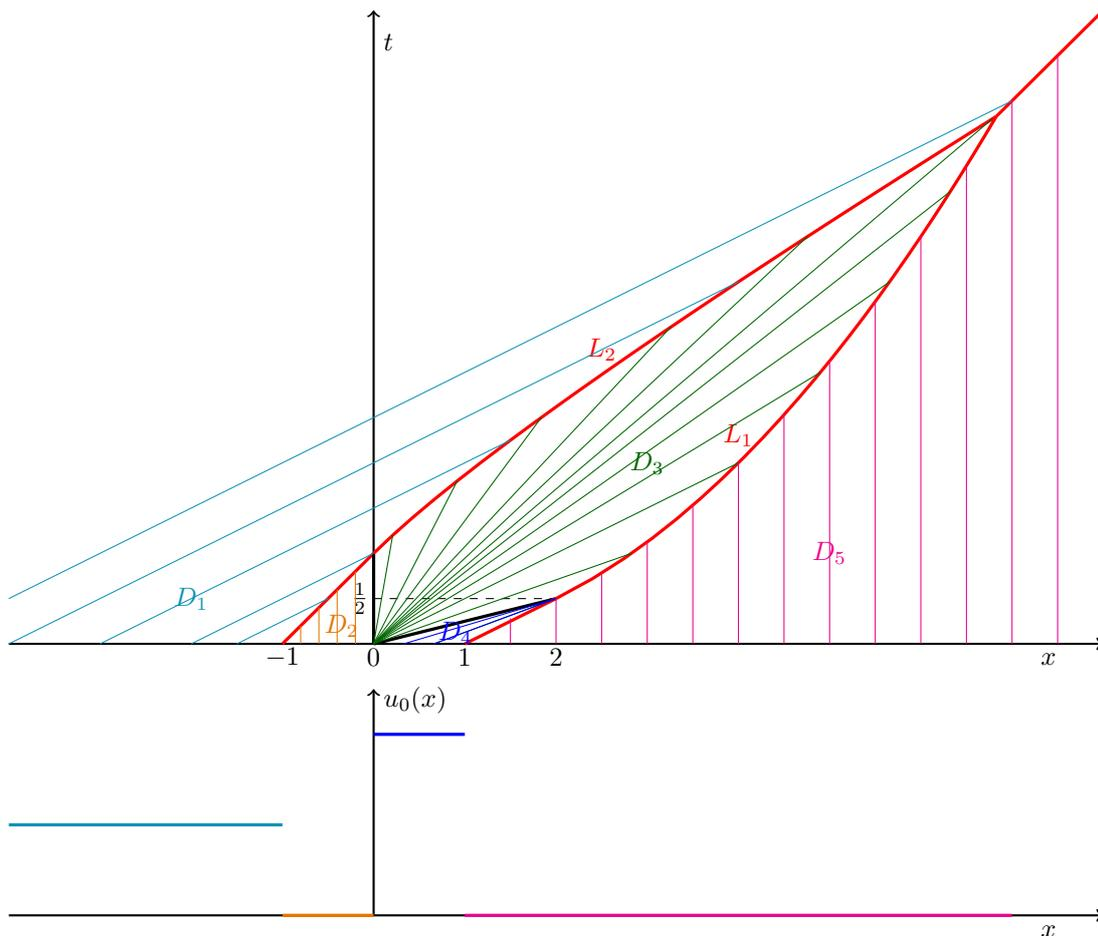
Figure 5.8: En haut : Droites caractéristiques pour l'équation de Burgers avec condition initiale  $u_0$  ; en rouge la ligne de choc, en noir les lignes de discontinuité  $C^1$  – En bas : allure de la condition initiale  $u_0$ .
