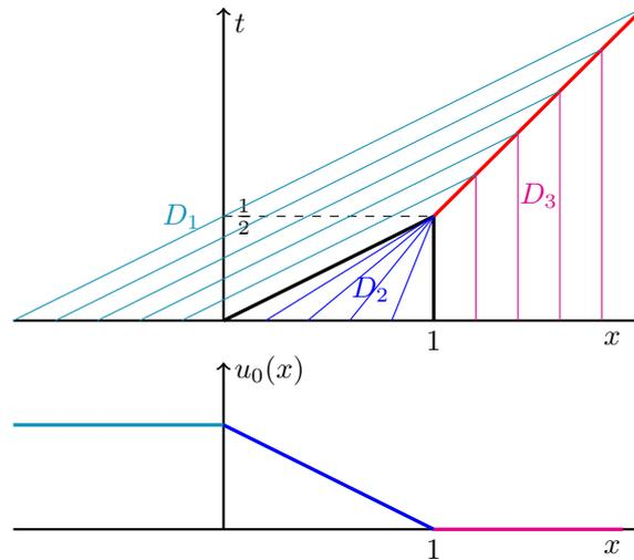
Figure 5.5: Exercice 5.4 page 225. En haut : Droites caractéristiques pour l'équation de Burgers avec condition initiale (5.50) En rouge la ligne de choc, en noir les lignes de discontinuité  $C^1$ . – En bas : allure de la condition initiale  $u_0$ .
