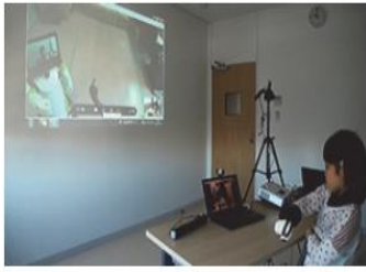
Figure 6. Interface du côté de l'opérateur. Deux écrans étaient disposés dans la salle où l'enfant se trouvait (un au mur et un autre sur un ordinateur portable). On observe que l'enfant porte un gant sur l'image, qui permet de contrôler des mouvements de préhension sur le robot. Tanaka et al. (2014).
