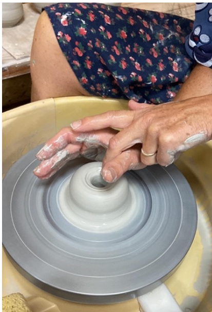
Figure 64. Perçage de la terre
