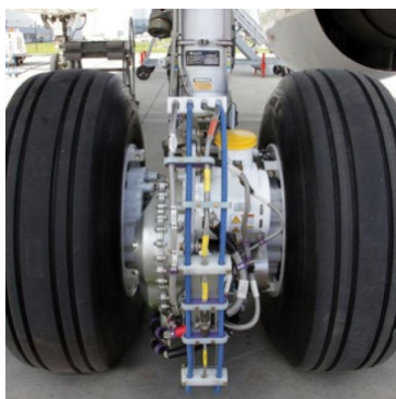
a. Roue motrice du train d'atterrissage fabriqué par Messier-Bugatti-Dowty
