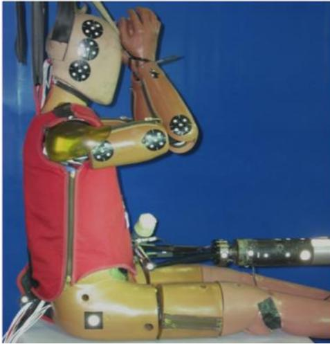
Figure 27 : Essai impacteur avec mannequin THOR NT
