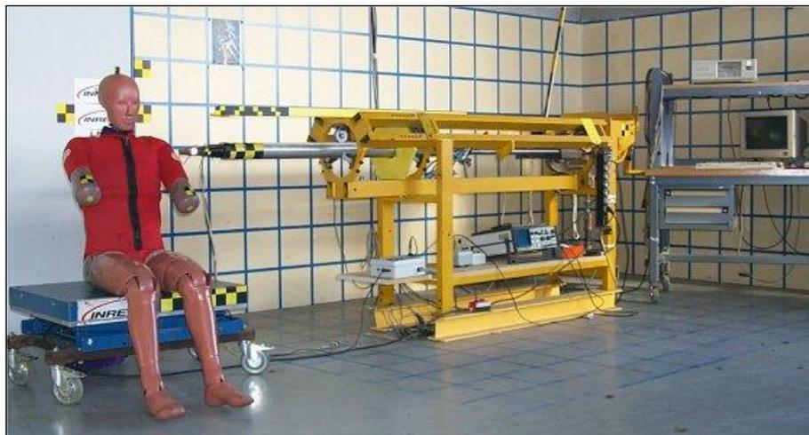
Figure 1 : Impacteur horizontal guidé
