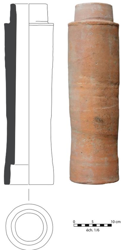
Fig. 13. Élément de canalisation en terre cuite de l'Hôtel-Dieu (dessin/DAO : C. Mège, F. Bertrand, d'après BERTRAND *et alii*, 2015, vol. 4, pl. 194).
